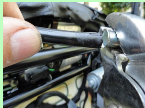
ภาพที่ 7 ปลอกโลหะหลุดจากปลอกยางแล้ว
