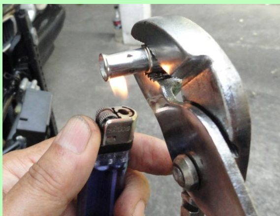
ภาพที่ 9 ให้ความร้อนปลอกโลหะเพื่อประกอบเข้ากับปลอกยาง
