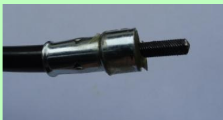
ภาพที่ 4 หลังปรับเพลาชับอ่อนโผล่ 10 มม.
