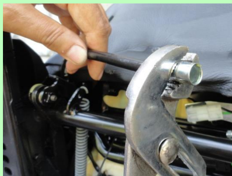
ภาพที่ 6 ดึงปลอกโลหะออกด้วยคีม
