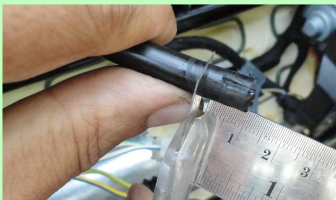
ภาพที่ 8 ตัดปลายปลอกยางออก 10 มม.
