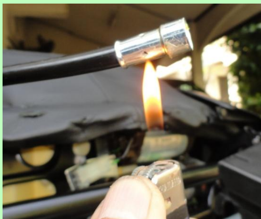
ภาพที่ 5 ให้ความร้อนปลอกโลหะโดยรอบด้วยไฟแช็ก LPG
